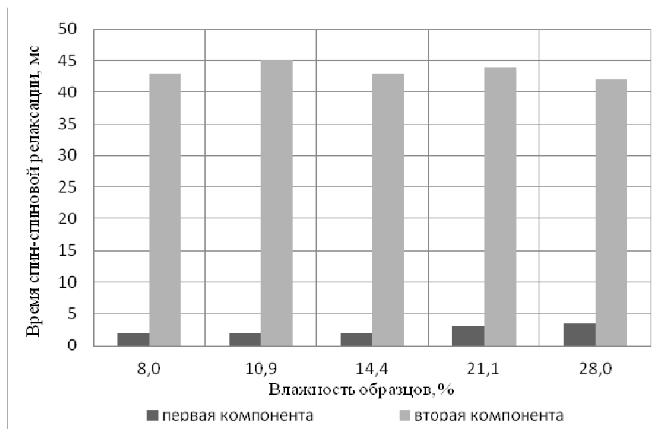
Рисунок 2 – Времена спин-спиновой релаксации протонов компонент воды, содержащейся в отрубях с различной влажностью, при температуре 23°C
