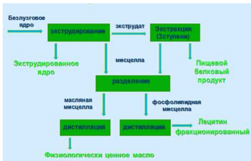
Рисунок 2 – Структурная схема переработки безлузгового ядра подсолнечника
